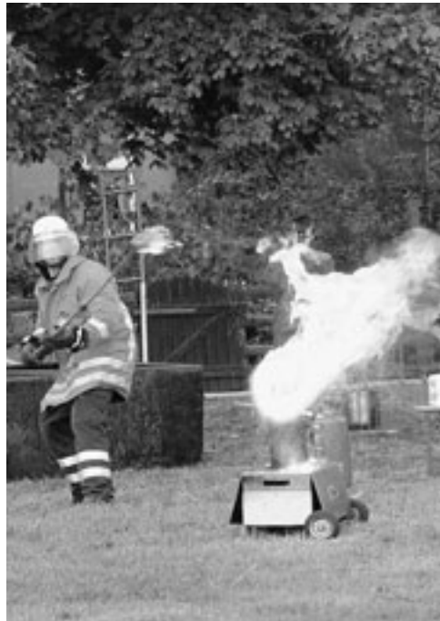
Das Verkehrteste bei einem Fettbrand ist, wie man an der Stichflamme sieht, der Versuch, ihn mit Wasser zu löschen.
